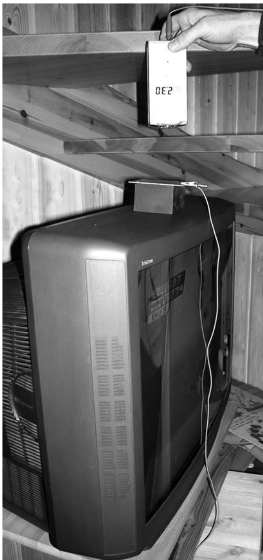
Figur 1: Forsøksoppsett for å vise hvordan en ledning foran en TV-skjerm kan føre til betydelig spenning på en metallplate (eller en MP3-spiller) i andre enden av ledningen. For nærmere forklaring, se teksten.
